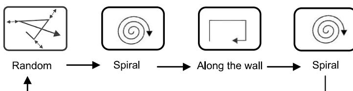
Robot će raditi dok se baterija na isprazni, dok se ne blokira na predmetima na podu, na pragovima ili dok se ne isključi na prekidaču. Robot signalizira da je baterija prazna – upalit će se crvena dioda na prekidaču.
