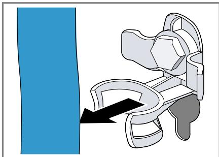
2. Λύστε και τις 4 βίδες των ασφαλειών μεταφοράς με ένα κλειδί με άνοιγμα κλειδιού 13 ① και αφαιρέστε τες ②.
