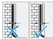
Μη μαγκώστε το καλώδιο σύνδεσης στο δίκτυο του ρεύματος και κανέναν εύκαμπτο σωλήνα μεταξύ του τοίχου και της συσκευής.
