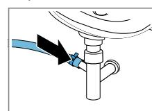
Ασφαλίστε το σημείο σύνδεσης με έναν οφιγκτήρα εύκαμπτου σωλήνα (24-40 mm).
