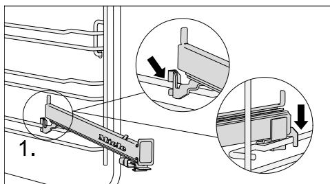
■ Τοποθετείτε τη συρόμενη ράγα FlexiClip μπροστά πάνω στο ανώτερο στήριγμα ενός επιπέδου στήριξης (1.).
