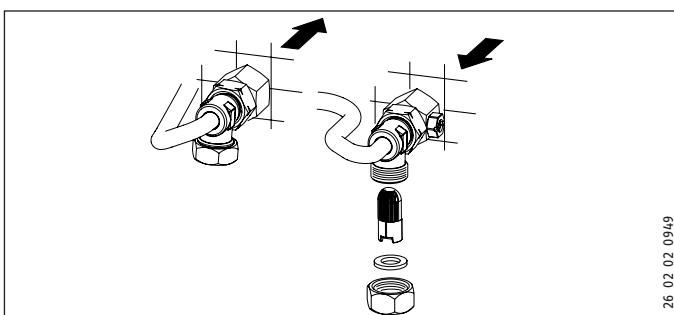
W razie zabrudzenia, oczyścić sitko w przyłączu zimnej wody. Podłączyć zawór odcinający przewodu doprowadzającego wody zimnej przez wymontowaniem, oczyszczeniem i ponownym zamontowaniem sitka.
