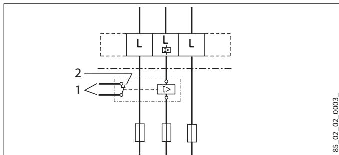
1 Управляващ проводник към защитния контактор на 2-ия уред (например електрически акумулиращ нагревателен уред).
