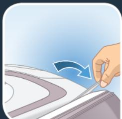
Ihre Dampfbügelstation ist mit einem Verriegelungssystem ausgestattet, welches das Bügeleisen auf der Basis fixiert, um den Transport und die Lagerung zu erleichtern. Tragen Sie die Dampfbügelstation am Griff des Bügeleisens:
