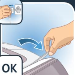
**Das Pro Express Ultimate ist mit einem Verriegelungssystem ausgestattet, dass das Bügeleisen auf der Basis fixiert, um den Transport und die Lagerung zu erleichtern.**
